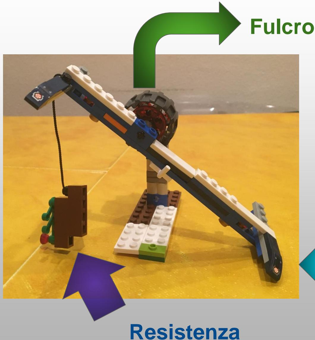
La mia leva è una leva di primo genere costruita in Lego, ha come **fulcro** la ruota, ha il **braccio della potenza** più lungo di quello della **resistenza**, è dunque vantaggiosa:
